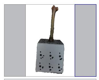
**Fig 1.** Setup used for taking photos and coded target points **Şekil 1.** Resim çekiminde kullanılan düzenek ve kodlu hedef noktaları
